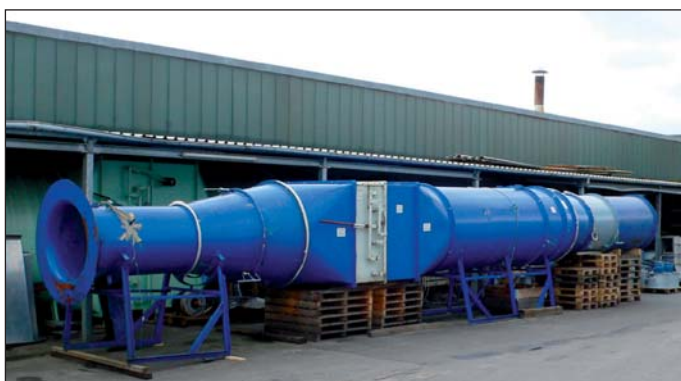
Obr. 3 Zkušební zařízení pro ventilátor podle ISO 5801 Fig. 3 Fan test rig according to ISO 5801
